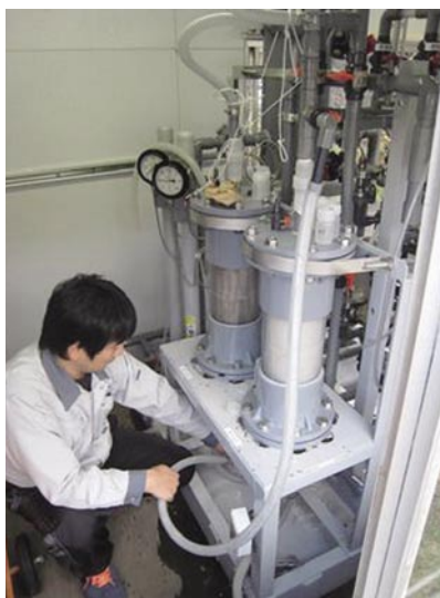
草津町に設置したスカンジウム捕集試験装置 草津温泉の湯川に流れ込んだ温泉水を捕集装置に通し、温泉水に含まれるスカンジウムを捕集した後、回収する。
